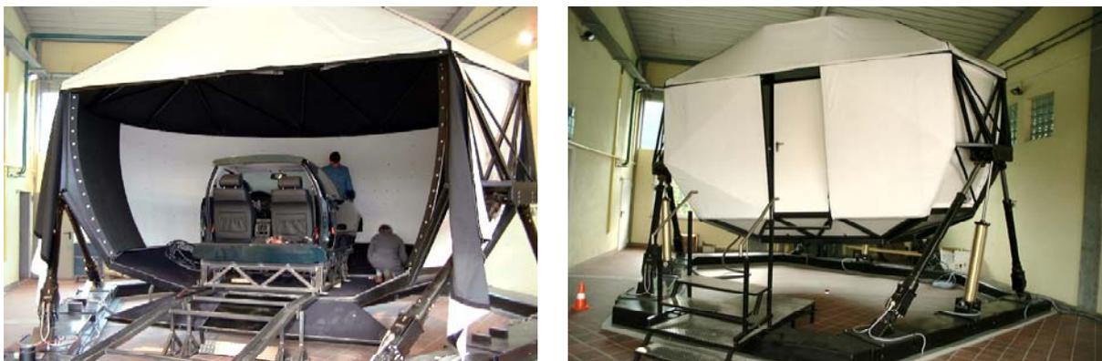
Abbildung 4: Würzburger Fahr Simulator mit elektrischem Bewegungssystem (6 Freiheitsgrade), 3-Kanal Frontprojektion (180 Grad) und 3-Kanal Rückraumprojektion (Spiegel).
